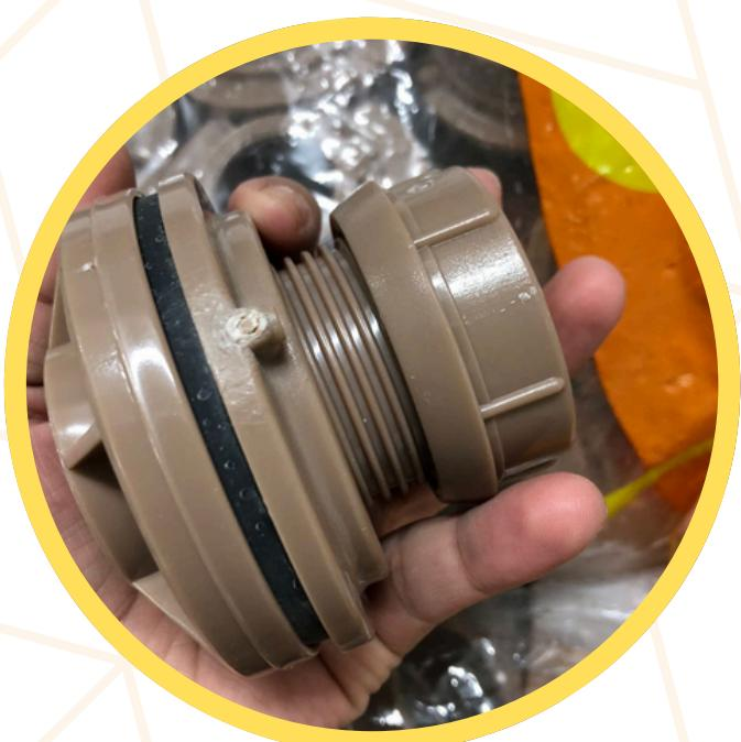
**Troca de Flanges:** A troca de flanges será feita com o desligamento da tubulação, remoção das peças danificadas e instalação das novas com vedação adequada. Após a fixação, serão realizados testes para garantir a estanqueidade do sistema.
